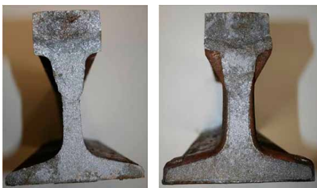
9 pav. Suvirintos termitiniu būdu bėgio jungties BHHD 5 min. lūžis. Jokių matomų defektų. Suadymo apkrova 1332 kN, įlinkis 9 mm
