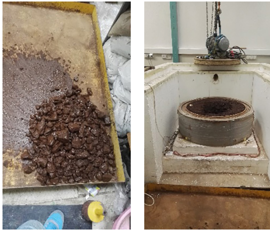
4 pav. Bandinio paruošimas šilumos laidžiui nustatyti: a) – medžiagos ėminys; b) – bandinio forma
