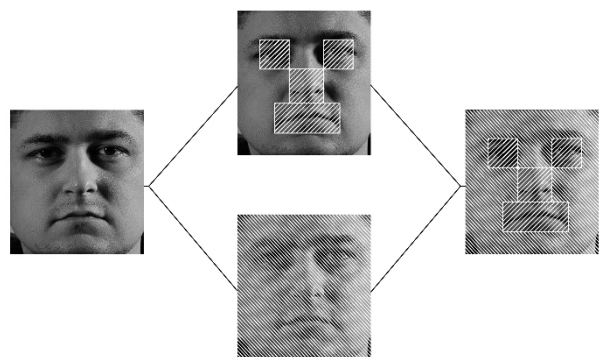
2 pav. Siūlomas normalizavimo metodas. Didelio ir mažo mastelių požymių regionai yra tiesiogiai atskiriami, normalizuojami dviem skirtingais algoritmais ir sujungiami į vieną nuotrauką
